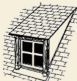
Lucarne rampante ou en chien couché
